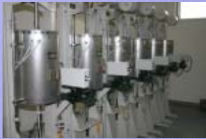
非接触型 クリープ試験装置 Creep test machine using non-contact extensometer
