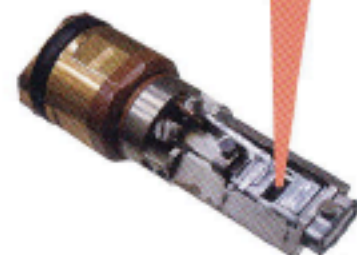
その場観察クリープホルダー In-situ creep holder (~1200°C)
